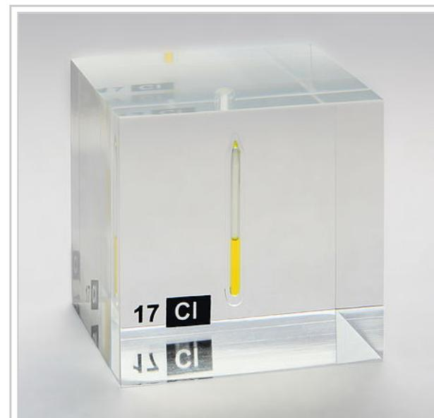
flüssiges Chlor in Quarzampulle, zur Sicherheit eingegossen in Acrylglas; Druck etwa 6700 hPa
