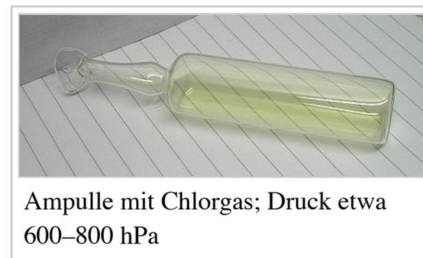
verflüssigen. So ist es bei einem Druck von 6,7 bar bei 20 °C flüssig und lässt sich in Stahlflaschen oder Kesselwagen transportieren.<sup>[29]</sup> Die Intensität der Farbe nimmt bei geringerer Temperatur ab, bei -195 °C ist Chlor fast farblos.<sup>[30]</sup>
